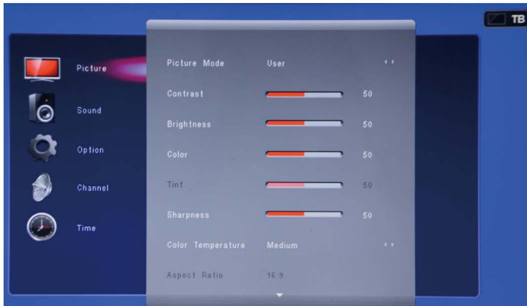
**Picture Mode** – Режим изображения. Выбрав определенный режим изображения, вы можете одновременно отрегулировать различные параметры изображения. Выберите из списка режим, который вам подходит: Standard (Стандартный), Dynamic (Динамический), User (Пользовательский) или Mild (Мягкий). При выборе режима User (Пользовательский) вы можете затем настроить контрастность (Contrast), яркость (Brightness), цветность (Color) и резкость (Sharpness).
