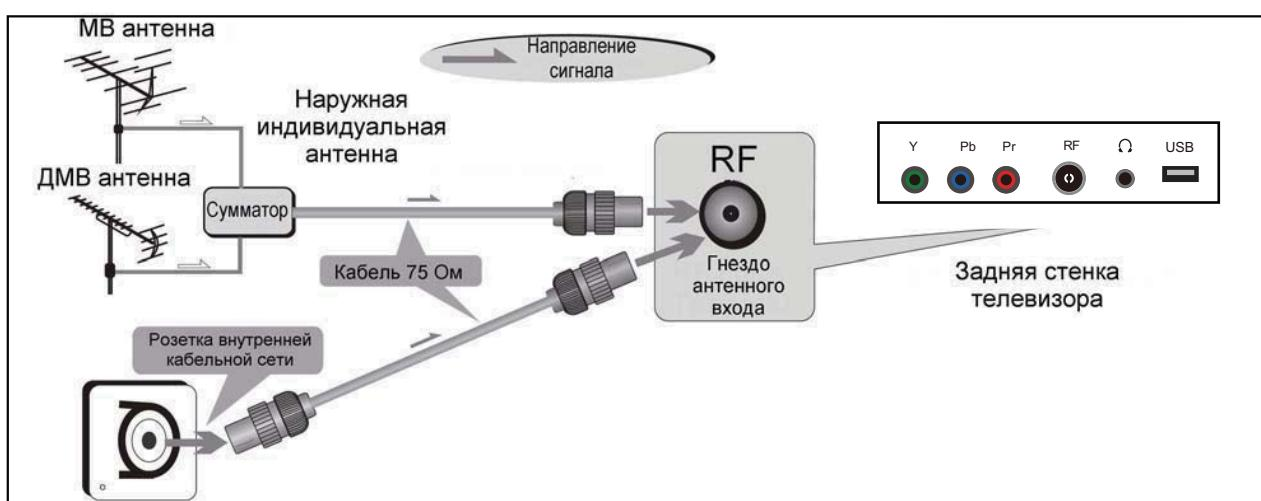
Присоедините при помощи телевизионного кабеля (75 Ом) антенный вход телевизора:
