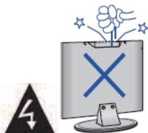
Никогда не вставляйте посторонние предметы в вентиляционные отверстия и открытые части телевизора. При эксплуатации телевизора используется высокое напряжение. Попадание посторонних предметов внутрь телевизора может послужить причиной поражения электрическим током и привести к повреждению деталей телевизора.
