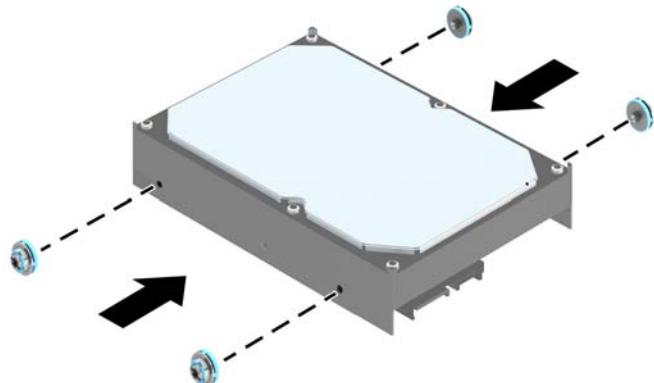
10. Совместите винты с гнездами на корпусе корзины диска, нажмите на жесткий диск по направлению к отсеку, а затем задвиньте его вперед до упора и фиксации на месте.
