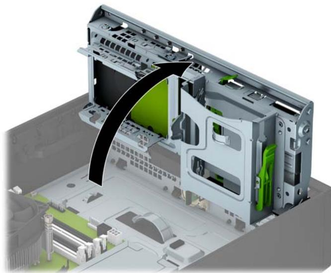
9. Вставьте диск в отсек (1), затем подсоедините кабель питания (2) и кабель данных (3) к разъемам на задней части жесткого диска
