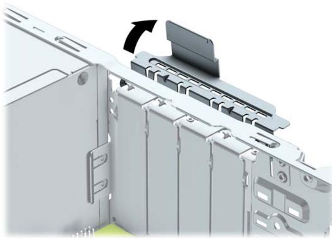
9. Перед установкой платы расширения снимите крышку гнезда расширения или уже установленную плату расширения.
