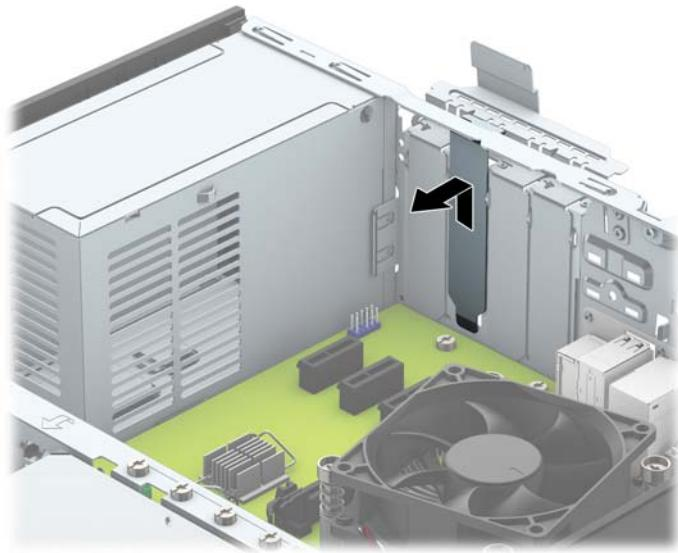
6. При извлечении платы расширения PCI Express x1 возмите ее за оба края и аккуратно покачайте, чтобы извлечь разъемы из гнезда. Вытащите плату расширения из разъема (1) вертикально вверх и извлеките ее из корпуса (2). Постарайтесь не поцарапать плату о другие компоненты.
