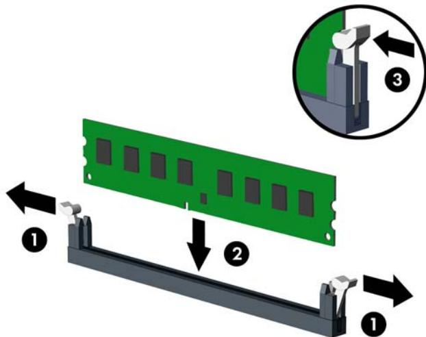
**💡 ПРИМЕЧАНИЕ.** Модуль памяти может иметь только одно положение при установке. Совместите вырез на модуле памяти и выступ на разъеме системной платы.
