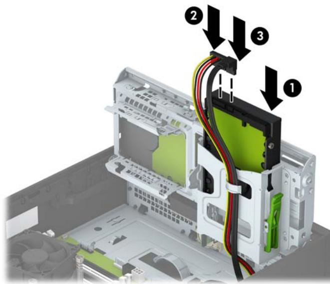
10. Поверните блок дисководов в обратном направлении, установив его в обычное положение.
