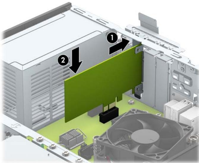
**ПРИМЕЧАНИЕ.** При установке платы расширения надавите на нее с усилием так, чтобы контакты разъема правильно вошли в гнездо платы расширения.
