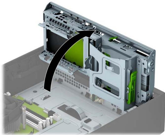
9. Совместите винты на жестком диске с J-образными пазами на сторонах отсека. Подтолкните диск вверх в отсек, затем сдвиньте его вперед до щелчка и фиксации на месте.
