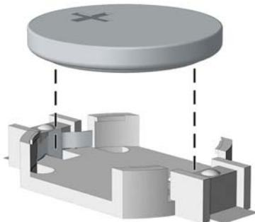
6. Вставьте новую батарею в держатель положительным полюсом вверх. Защелка держателя батареи автоматически зафиксирует батарею в нужном положении.
