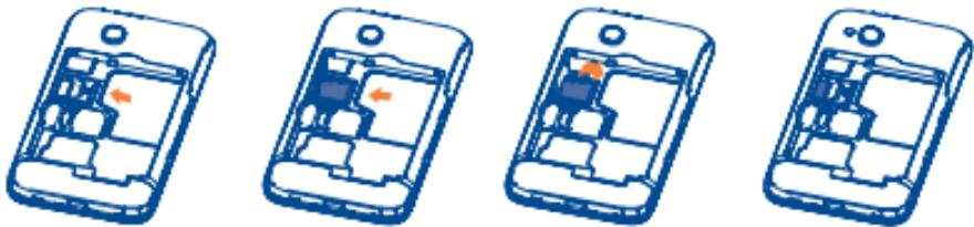
Чтобы установить, пожалуйста, откройте блокиратор microSD-карты, а затем поместите microSD-карту в слот контактами вниз. Чтобы извлечь microSD-карту, откройте блокиратор microSD-карты и достаньте ее из слота.
