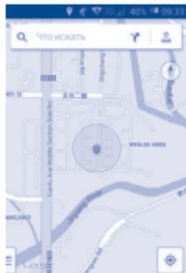
Используйте встроенный в телефон приёмник GPS для определения своего местоположения с точностью до нескольких метров. При первом запуске телефона может потребоваться до 5 минут на определение вашего местоположения. При этом телефон должен находиться под открытым небом и не должен перемещаться. В дальнейшем ваше местоположение будет определяться в течение 20-40 секунд, однако и в этом случае телефон должен находиться под открытым небом.
