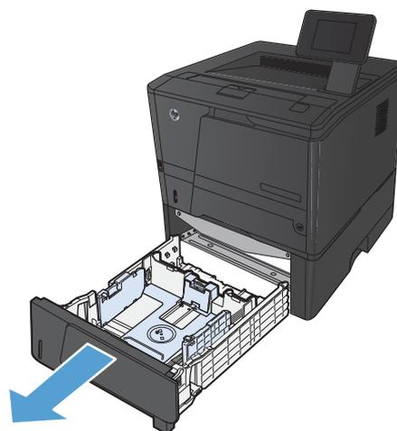
2. Раскройте направляющие (по длине и ширине) бумаги, нажав на синие фиксаторы.
