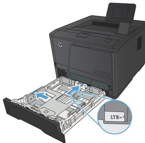
3. Чтобы загрузить бумагу формата Legal, выдвиньте лоток. Для этого нажмите на кнопку в задней части лотка и потяните заднюю часть лотка на себя.
