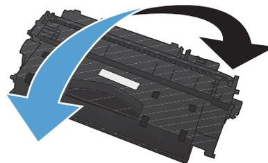
4. Сгибайте язычок на левой стороне картриджа, пока он не сломается. Потянув за язычок, полностью удалите предохранительную ленту из картриджа. Положите язычок с лентой в упаковку картриджа с тонером для последующего возврата на утилизацию.
