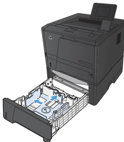
3. Чтобы загрузить бумагу формата Legal, выдвиньте лоток. Для этого нажмите на кнопку в задней части лотка и потяните заднюю часть лотка на себя.
