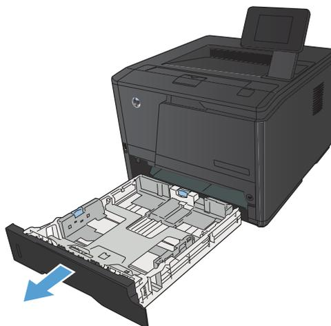
2. Раскройте направляющие (по длине и ширине) бумаги, нажав на синие фиксаторы.
