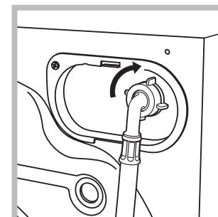
2. Кіріс түтігінің екінші жағын кр жуғыш машинаның артқы жағының жоғарғы оң жағында орналасқан су кірісіне бұрау арқылы жалғаңыз (суретті қараңыз).
