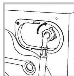
2. Приєднайте заливний шланг до пральної машини, нагвинтивши його на водоприймач, розташований у задній верхній частині справа (див. мал.).
