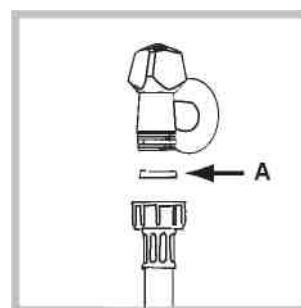
1. Вставте прокладку А в кінець заливного шланга й накрутіть його на вивід водопроводу холодної води з різьбовим отвором 3/4 дюйма (див. мал.).
