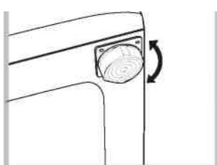
2. Після установки машини на місце відрегулюйте її стійке положення шляхом обертання передніх ніжок (див. мал.). Для цього спочатку послабте контргайку, після завершення регулювання контргайку затягніть. Після установки машини на місце перевірте за рівнем горизонтальність верхньої
