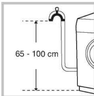
Повісьте загнутий кінець зливного шланга на край раковини, ванни, або помістіть в спеціальний вивід каналізації. Шланг не повинен перегинатися. Верхня точка зливного шланга повинна перебувати на висоті 65-100 см від підлоги. Розташування зливного шланга повинне забезпечувати розрив струменя при зливі (кінець шланга не повинен бути опущений у воду). У випадку кріплення на край ванної або раковини, шланг вішається за допомогою спрямуючої (входить у комплект поставки), що кріпиться до крана (мал.).
