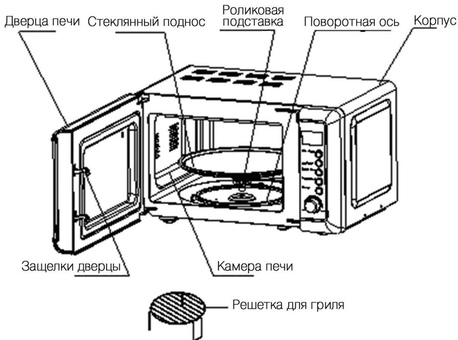
На поворотную ось устанавливается стеклянный поднос. Под стеклянный поднос устанавливается роликовая подставка, которая помогает подносу свободно вращаться. Вращение пищи во время работы печи способствует ее равномерному приготовлению.
