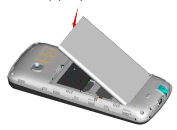
• Закройте крышкой аккумуляторный отсек и нажмите на неё до фиксации.
