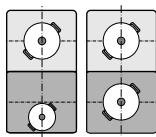
Передняя и задняя конфорки с двумя индукторами в каждой могут использоваться независимо, так что уровень мощности задается для каждой из них отдельно. В этом случае рекомендуется использовать только один предмет посуды в каждой зоне.
