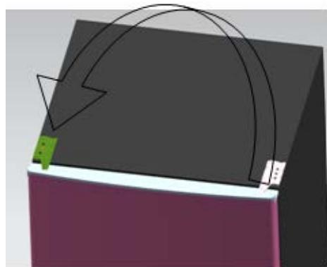
10. Установите/прикрепите верхнюю дверь, зафиксируйте верхнюю петлю и крышку/накладку.
