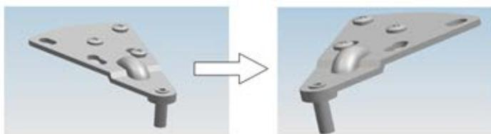
В. Снимите ограничитель хода (стопор).
